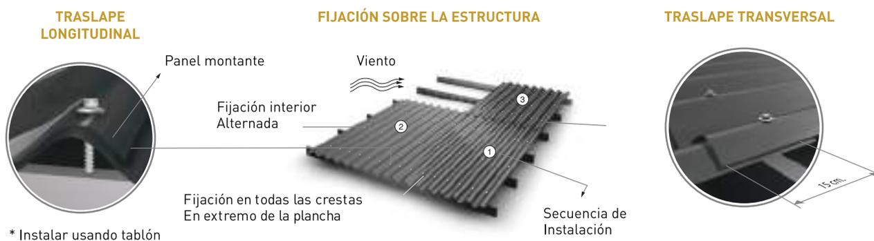
Fije las planchas sobre la estructura perforando siempre En la cresta. Coloque los accesorios como se indica en el gráfico
